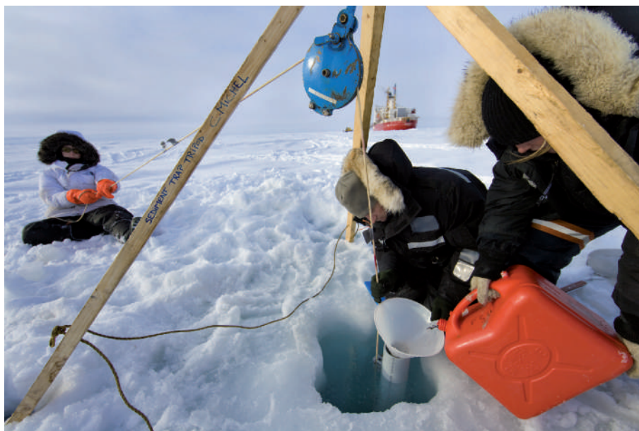
FIGURE 7. Préparation avant déploiement de trappes à sédiment sous la banquise. Ces trappes à sédiment seront placées à différentes profondeurs sous la glace pour permettre de collecter les particules qui sédimentent dans la colonne d'eau. Ces particules peuvent par exemple être des algues de glace qui se sont détachées de leur substrat. À l'aide de ces trappes, il est ensuite possible d'estimer la quantité de matériel organique qui transite vers le fond des océans en participant à la séquestration du carbone atmosphérique. Sud-est de la mer de Beaufort, Mai 2008. De gauche à droite : Chantal Lacoste (étudiante en maîtrise d'océanographie à l'Institut des sciences de la mer de Rimouski, Université du Québec à Rimouski, UQAR, Canada), Christian Nozais, (Professeur-chercheur, Département de biologie et centre d'études nordiques, Université du Québec à Rimouski, Québec, Canada), Amélie Sallon (étudiante en maîtrise d'océanographie à l'Institut des sciences de la mer de Rimouski, Université du Québec à Rimouski, UQAR, Canada). © Christian Morel / www.ourpolarheritage.com.
