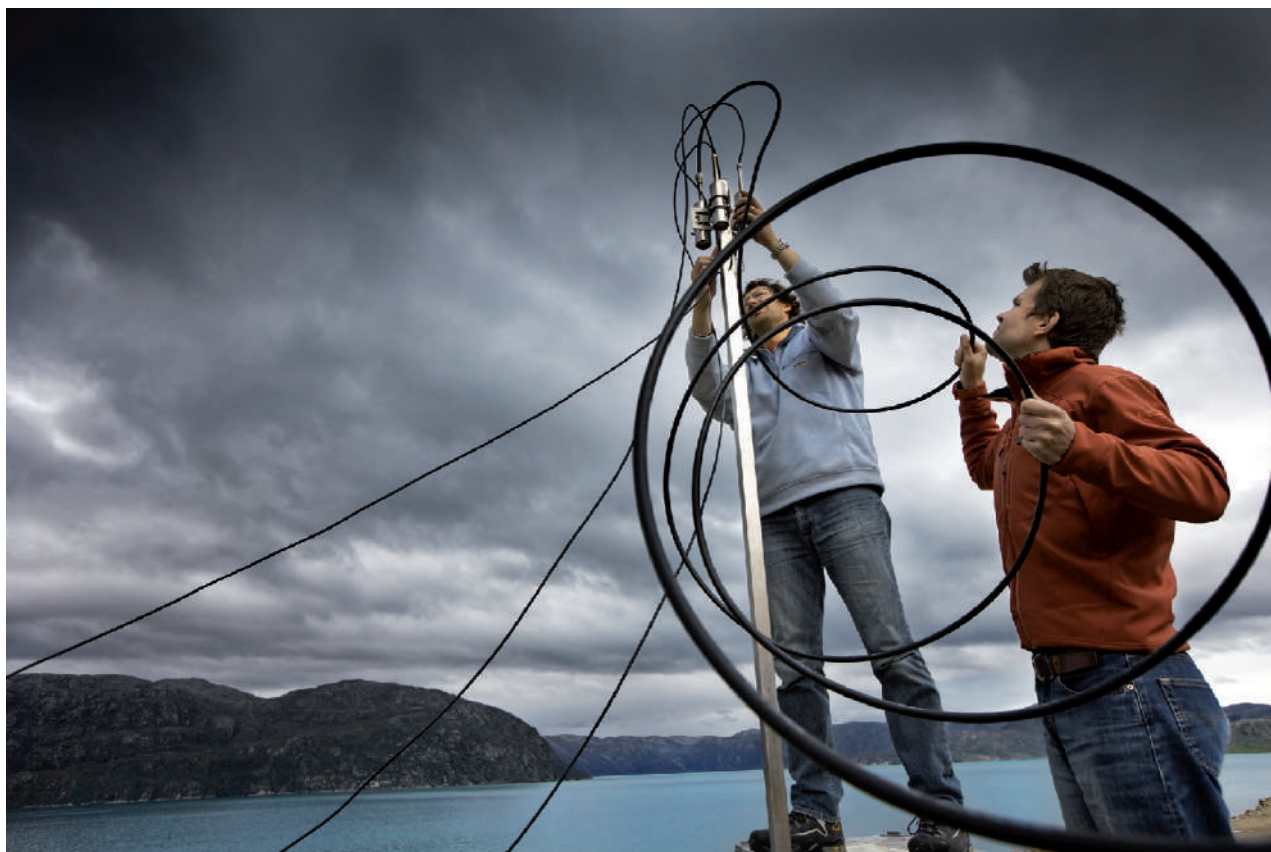
FIGURE 9. Installation des capteurs et lignes de prélèvement d'air sur un mât de 2 mètres de hauteur en vue d'obtenir les mesures de concentration en dioxyde de carbone et en oxygène de l'atmosphère. Station de mesure de Ivigtut, côte sud-ouest du Groenland, Août 2007. De gauche à droite : Marc Delmotte (Docteur es Science, Ingénieur de Recherche au CNRS, Laboratoire des Sciences du Climat et de l'Environnement, (UMR 1572 CEACNRS-UVSQ), Gif-sur-Yvette, France), Jošt Valentin Lavrič (Docteur es Science, Ingénieur CEA, France). © Christian Morel / www.our-polarheritage.com.
